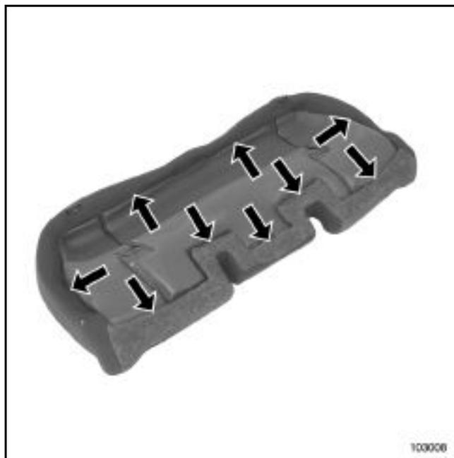
Déposer les profils de maintien de la coiffe.
