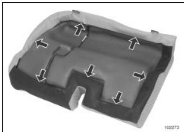
Déposer les profils de maintien de la coiffe.
