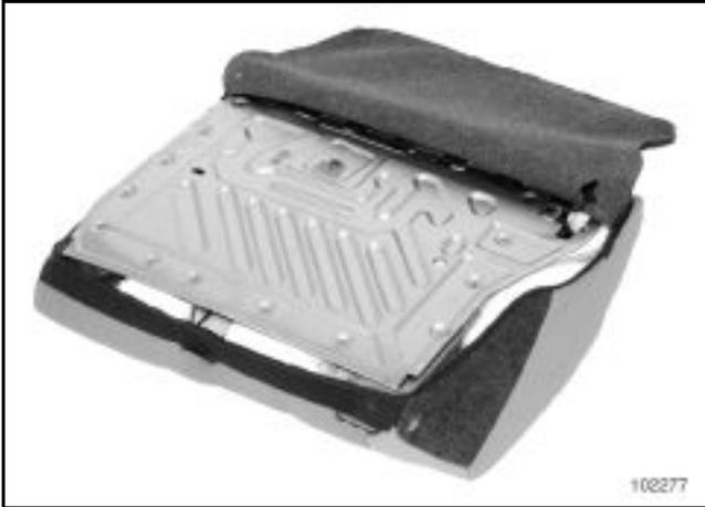
Dégarnir partiellement la coiffe afin d'accéder aux guides d'appui-tête.
